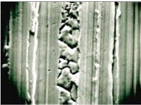
Erikoishaponkestävän teräksen 254 SMO pinta, joka on hiottu karkeudella 120. Pinnassa näkyy pitkiä naarmuja ja läikkiä.
