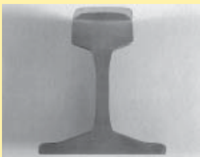
Hiili-mangaaniteräskisko: OK Tubrodur 15.43.
