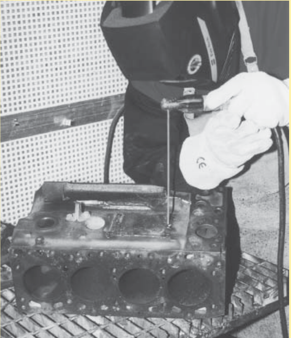
Valurautainen moottorilohko. Korjaus puikoilla OK 92.18 ja OK 92.60.
