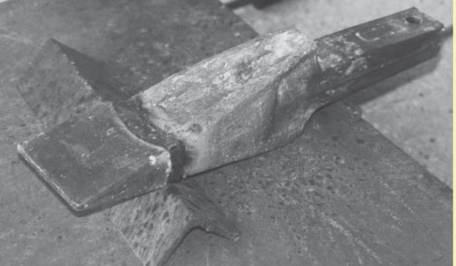
Korjauskärkien kiinnitys kauhan kynnen runkoon lisäaineella OK 67.45 tai OK Tubrodur 14.71.
