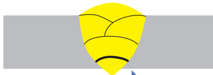
Liitosvirhe palkojen välissä
