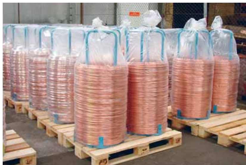
Lankana käytetään OK Autrod 12.32, jota toimitetaan asiakasta varten suunnitelluissa suurpakkauksissa.
