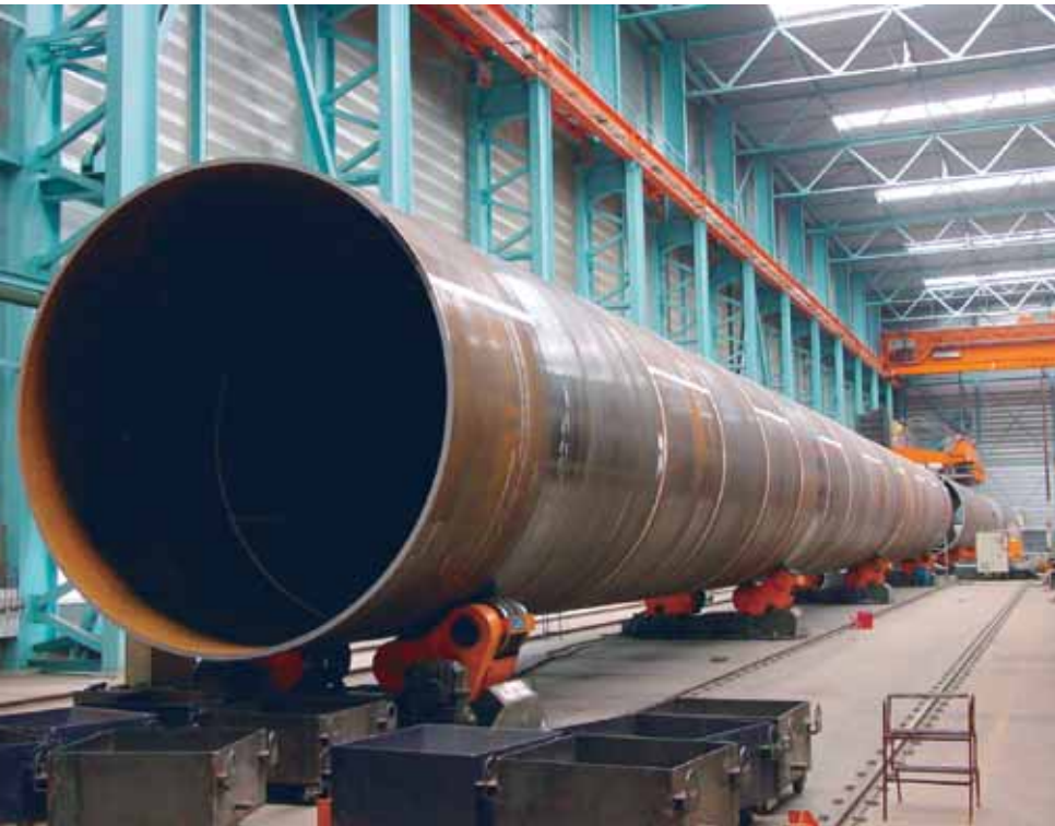
Valmistusvaiheessa oleva yksittäinen paalu.
