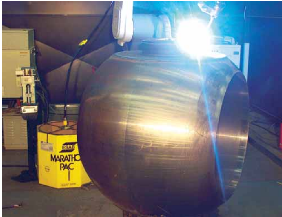
Pallon MIG/MAG-pinnoitusta robotilla.
