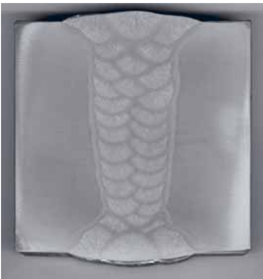
Poikkileikkaus tyypillisestä hitsistä 70 mm paksussa materiaalissa.
